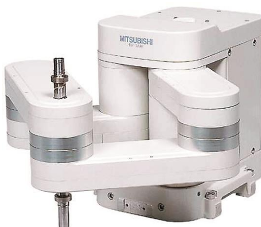
Doppelarm-SCARA Roboter mit Parallelkinematik
