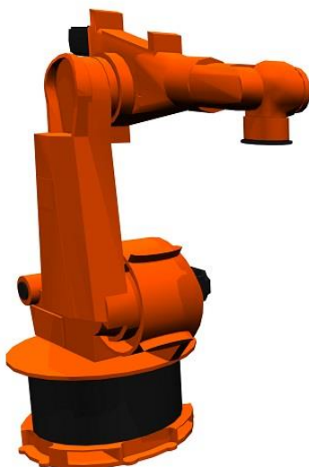
Vertikaler 6-achsiger Knickarmroboter
