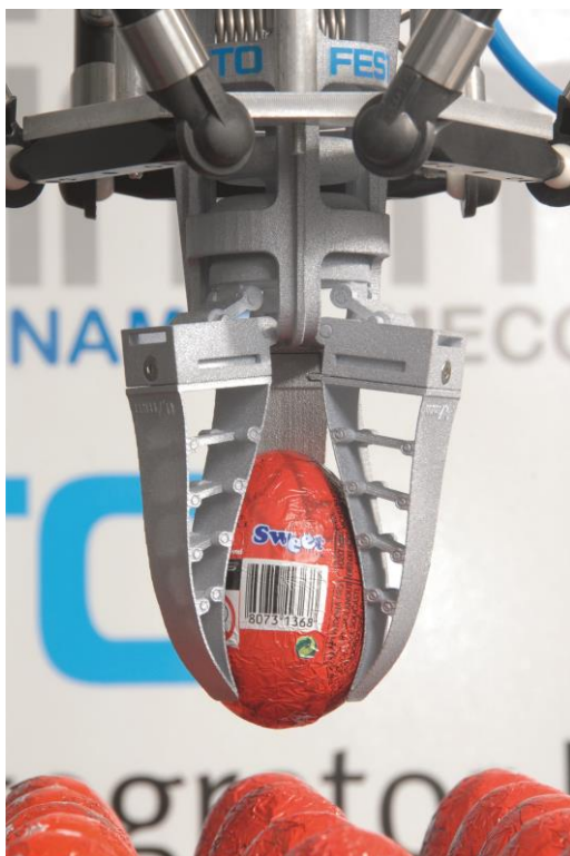
Pneumatischer Greifer mit Fin Ray Effect®
